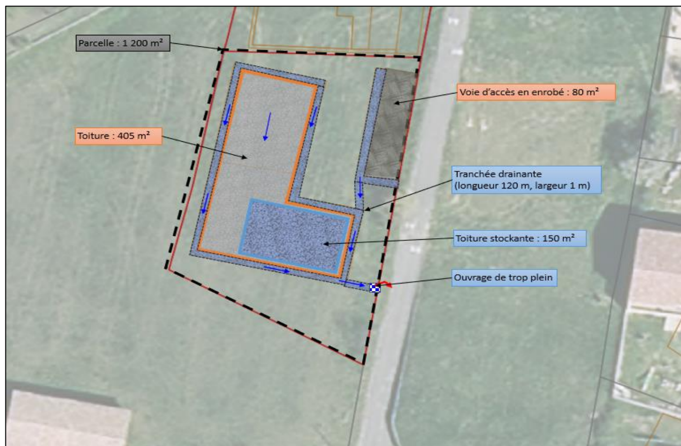
Illustration 24 : Exemple d'aménagement pour un petit immeuble collectif
