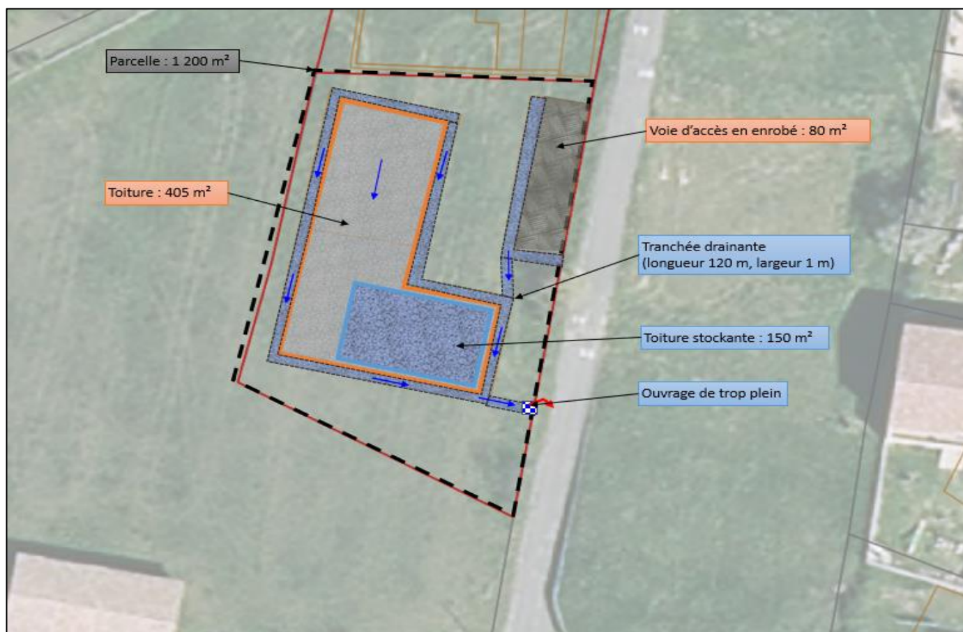
Illustration 24 : Exemple d'aménagement pour un petit immeuble collectif
